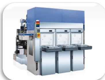
半導体の製造は、下図のような真空容器中で、様々なガス、温度条件等を使用してつくられます。真空容器他は、製品の製造とともにガス等の反応生成物により汚れていき、その汚れの除去の為、定期的に洗浄する必要があります。
